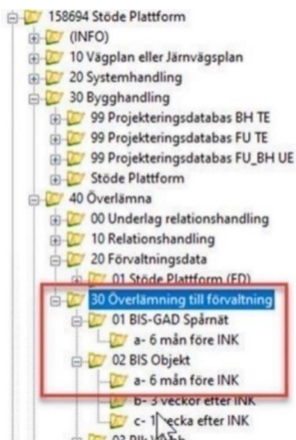
Bild 2. Bilden visar mappstruktur för leverans av data till BIS och GAD, med leveranstidskravet 6 månader före inkoppling.
