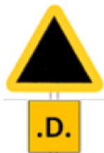
Figur 1. Orienteringstavla för detektoranläggning
