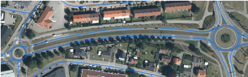
Figur 5 Fysiskt skilda körbanor mellan två korsningar - körbanemitt, en linje per riktning
