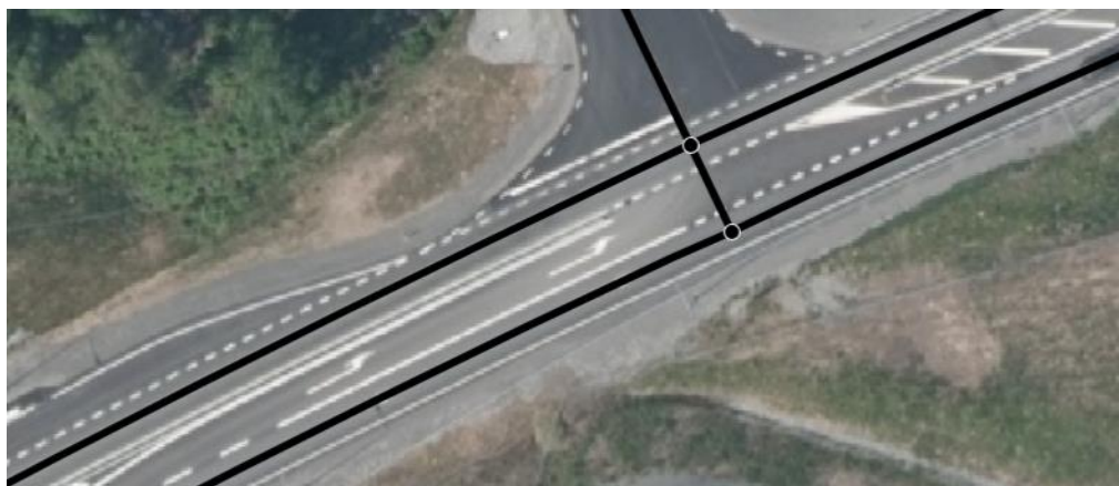
Figur 55 Tvärlänk vid korsning med vänstersväng på 2+1-väg.
