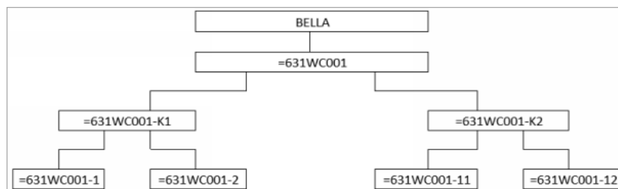
Figur 4.11.2-3 Kravprincip för Central med tändsteg samt grupper.
